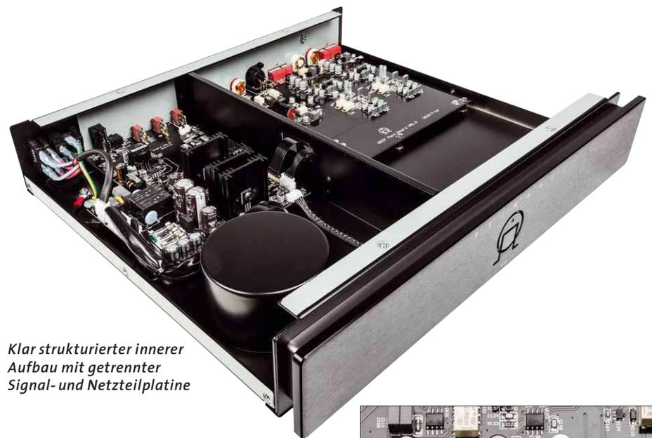
Klar strukturierter innerer Aufbau mit getrennter Signal- und Netzteilplatine
